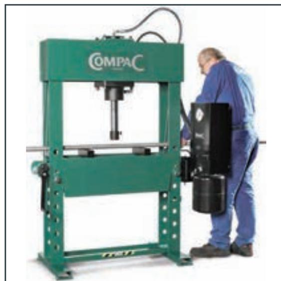
Une pompe montée sur support en équerre qui peut pivoter de 90° et permet l'introduction de pièces à usiner de grande longueur.
