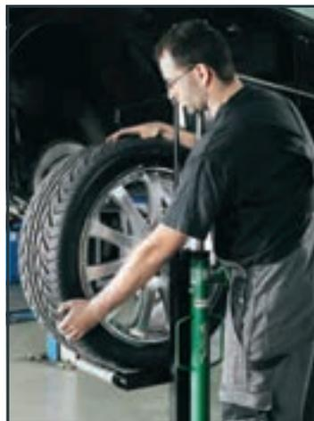
*Rotation et positionnement de la roue facilités, grâce aux galets montés sur roulements à billes*
