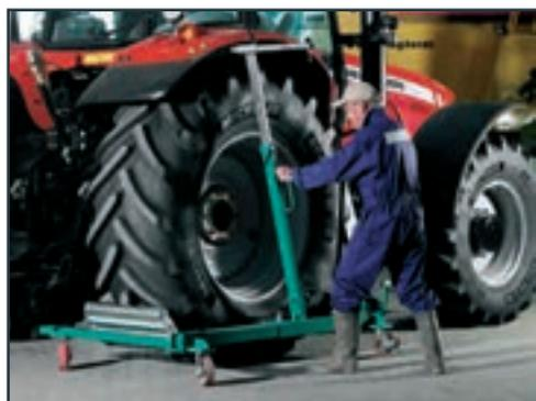
Facilité de manipulation de roues de grandes dimensions, Ø 1 250 mm à 2 400 mm, largeur jusqu'à 1 050 mm
