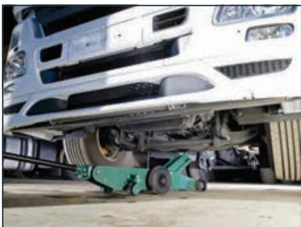
La longue portée du châssis facilite l'accès aux points de levage éloignés sous des camions et autobus.
