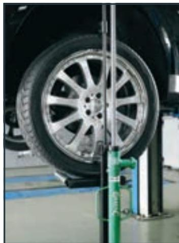
*Accès facile aux écrous, la roue est positionnée à l'écart du piston principal*
